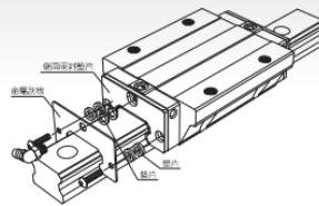
可排除高溫鐵屑與焊接火花等大型異物，並防止端面密封墊片因而被破壞之配件。
